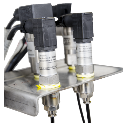
BATTERIA DI TRASDUTTORI DI PRESSIONE
